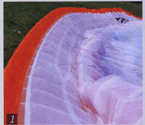
Die Shark Nose am R11 von Ozone mit ihren minimalistischen Eintrittsöffnungen. Foto: Baki Shakirovski
