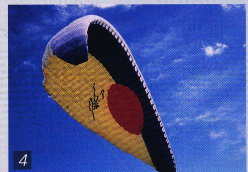
Der Wettkampfschirm Minoa von Swing aus dem Jahr 1994. Die rückversetzten Eintrittsöffnungen und das konkave Profil in diesem Bereich kommen der Shark Nose von Ozone schon relativ nahe. Foto: Swing
