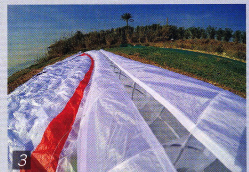
Am neuen GTO 2 von Gin ist sehr schön erkennbar, wie Ober- und Untersegel zur Eintrittsöffnung nach innen zeigen und entsprechend durch kreuzende Stäbchen aufgespannt sind. Foto: Ziad Bassil
